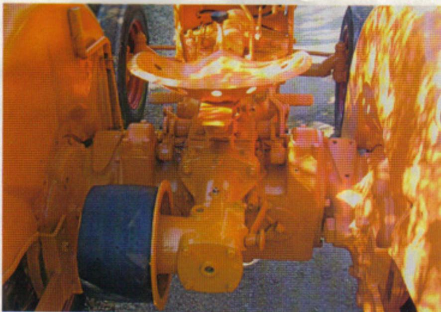
Il posto di guida del 600 era quanto di meglio potesse offrire la produzione europea del periodo come **protezione e confort dell'operatore**. In primo piano, la presa di potenza a puleggia che poteva essere sostituita dall'albero scanalato
